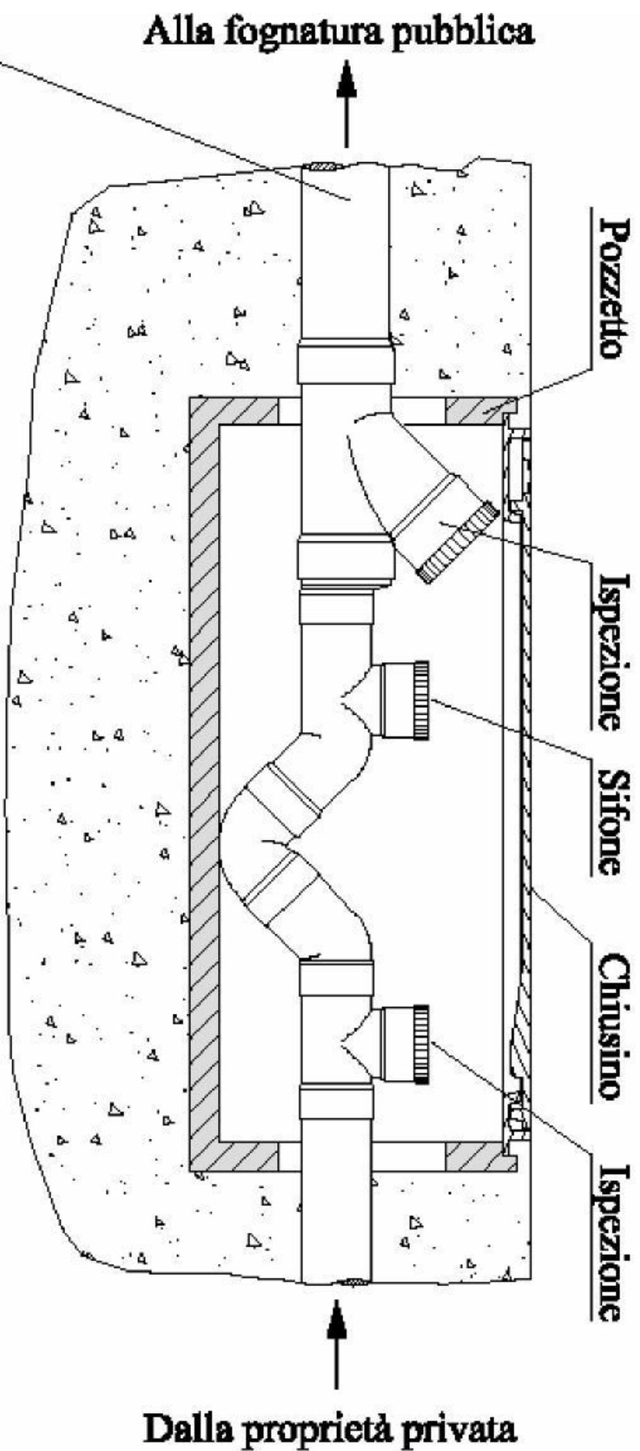
**Diametro interno minimo tubazione di allacciamento 140 mm - pendenza minima 2%**
